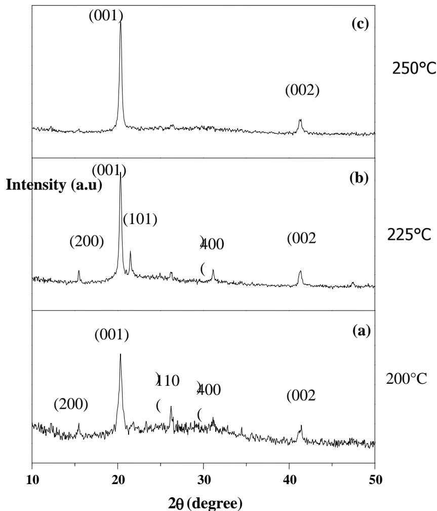
Figure 1 : XRD patterns of  $V_2O_5$  thin films
