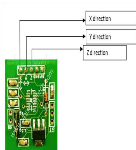
Figure 11 MEMS IC
