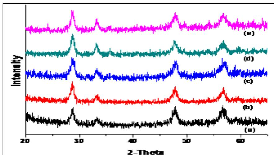
Fig 2: XRD pattern of (a) 0.1, (b) 0.3, (c) 0.5, (d) 0.8, (e) 1.0 wt. % Fe/CeO<sub>2</sub> mixed oxide catalyst
